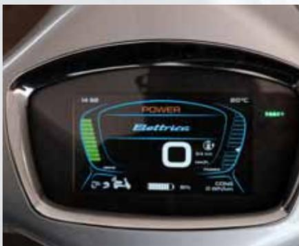
Der Tacho der Elettrica ist übersichtlich gestaltet. Sobald das grüne Licht „READY“ aufleuchtet kann es losgehen. Im Eco-, Power- oder Rückwärtsmodus. Sogar die Temperatur wird angezeigt.
