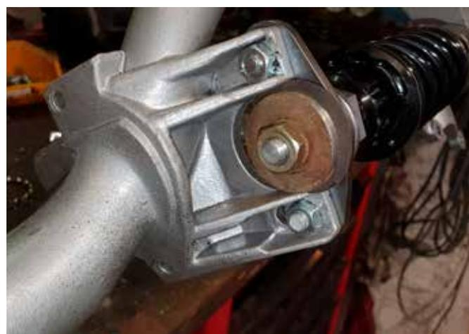
Dennoch zu bearbeiten: Stoßdämpferaufnahme/Stoßdämpferersatz (Adapterplatten gibt es vorgefertigt zu kaufen) und Dämpferaufnahme unten bitte unbedingt mit Distanzplättchen montieren, spielfrei. Oben muss die leichte Bohrung bearbeitet werden, damit der Dämpfer spannungsfrei sitzt.
